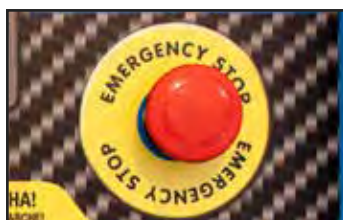
Parada de emergencia regulable antigolpes.
