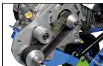
Transmisión POLY-V para mayor resistencia y eficacia.
