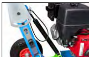
Regulación de profundidad por amortiguador de gas.
