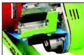
Asa delantera para la elevación manual.
